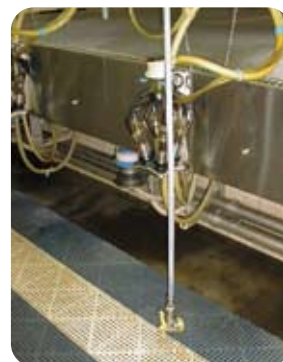
搾乳中に乳房や床洗浄をするためのホースノズル
